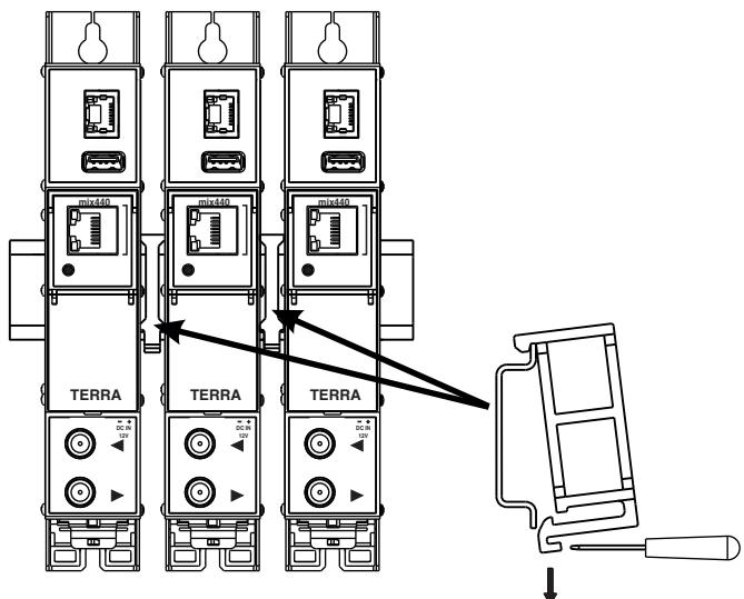
Рис. 5. Крепление или демонтаж с "DIN rail" пластиковых вставок (входят в комплект поставки).
